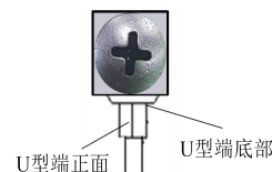
图 5 U 型冷压头与端子排连接示意图
